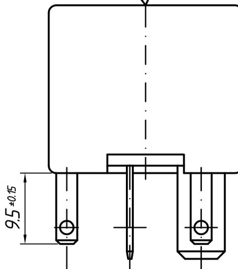
Gehäuse: PA66 mit 35% GF, schwarz; ( >PA 66-GF35 FRK ) UL 94: V-0; Teilekennzeichnung gedruckt; Datum auf einer Seite gepraegt oder gedruckt; Klemmenbezeichnung auf Anschlussseite
