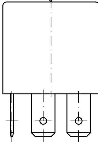
Gehäuse: PA66 mit 35% GF, schwarz; ( >PA 66-GF35 FRK ) UL 94: V-0; Teilekennzeichnung gedruckt; Datum auf einer Seite gepraegt oder gedruckt; Klemmenbezeichnung auf Anschlussseite
