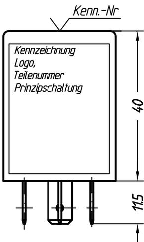
Gehäuse: PA66 mit 30 +/- 3% Glasfaser, schwarz; Teilekennzeichnung gedruckt;
