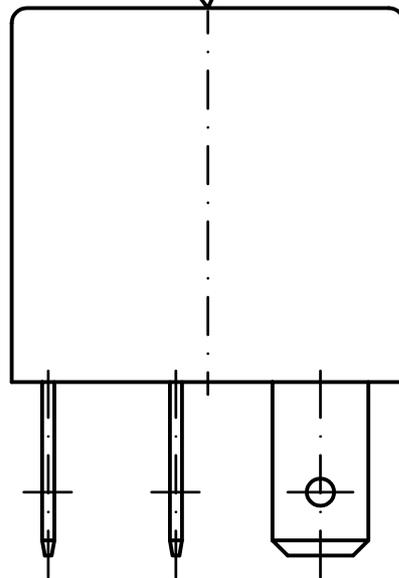
Gehäuse: PA66 mit 35% GF, schwarz; ( >PA 66-GF35 FRK ) UL 94: V-0; Teilekennzeichnung gedruckt; Datum auf einer Seite gepräget oder gedruckt; Klemmenbezeichnung auf Anschlussseite
