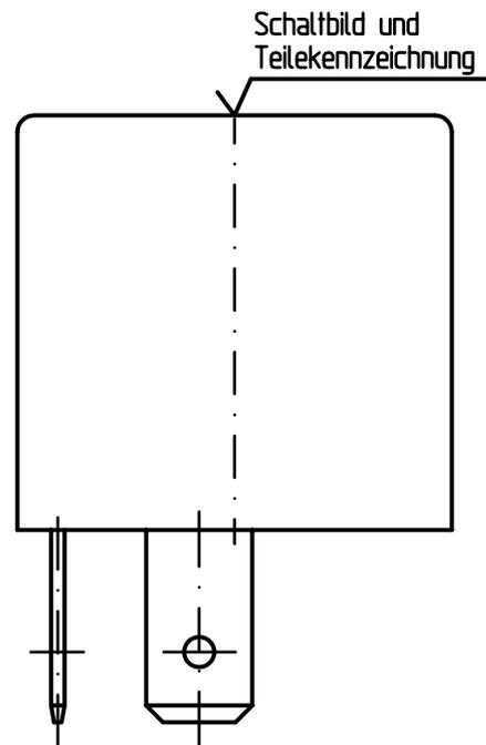
Gehäuse: PA66 mit 35% GF, schwarz; ( >PA 66-GF35 FRK ) UL 94: V-0; Teilekennzeichnung gedruckt; Datum auf einer Seite geprägt oder gedruckt; Klemmenbezeichnung auf Anschlussseite
