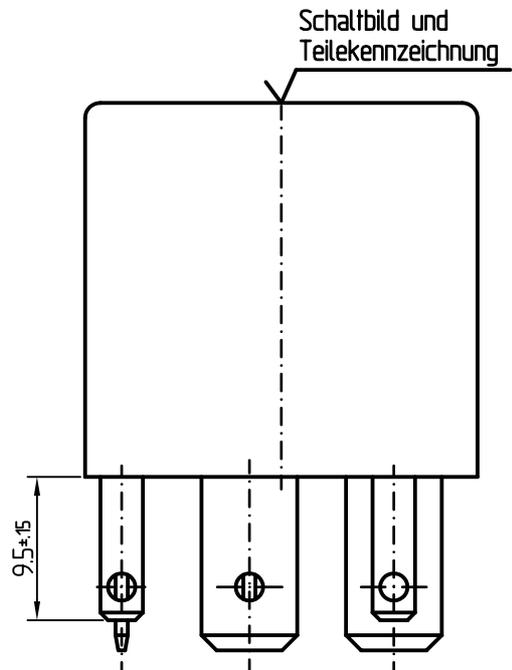
Gehäuse: PA66 mit 35% GF, schwarz; ( >PA 66-GF35 FRK ) UL 94: V-0; Teilekennzeichnung gedruckt; Datum auf einer Seite geprägt oder gedruckt; Klemmenbezeichnung auf Anschlussseite
